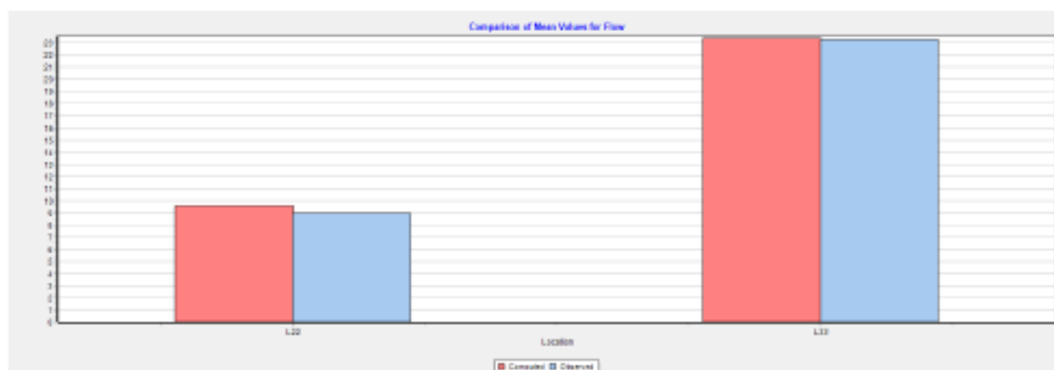
Figure 8 : Statistiques et erreur moyennes entre les débits mesurés et simulé à la station de pompage (L22) et en sortie du réservoir de Villiers (L33)
